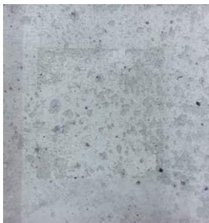
Abb. 31 Erscheinungsbild der Betonoberfläche mit unterschiedlicher Abwitterung bei der SIA-Prüfung.
