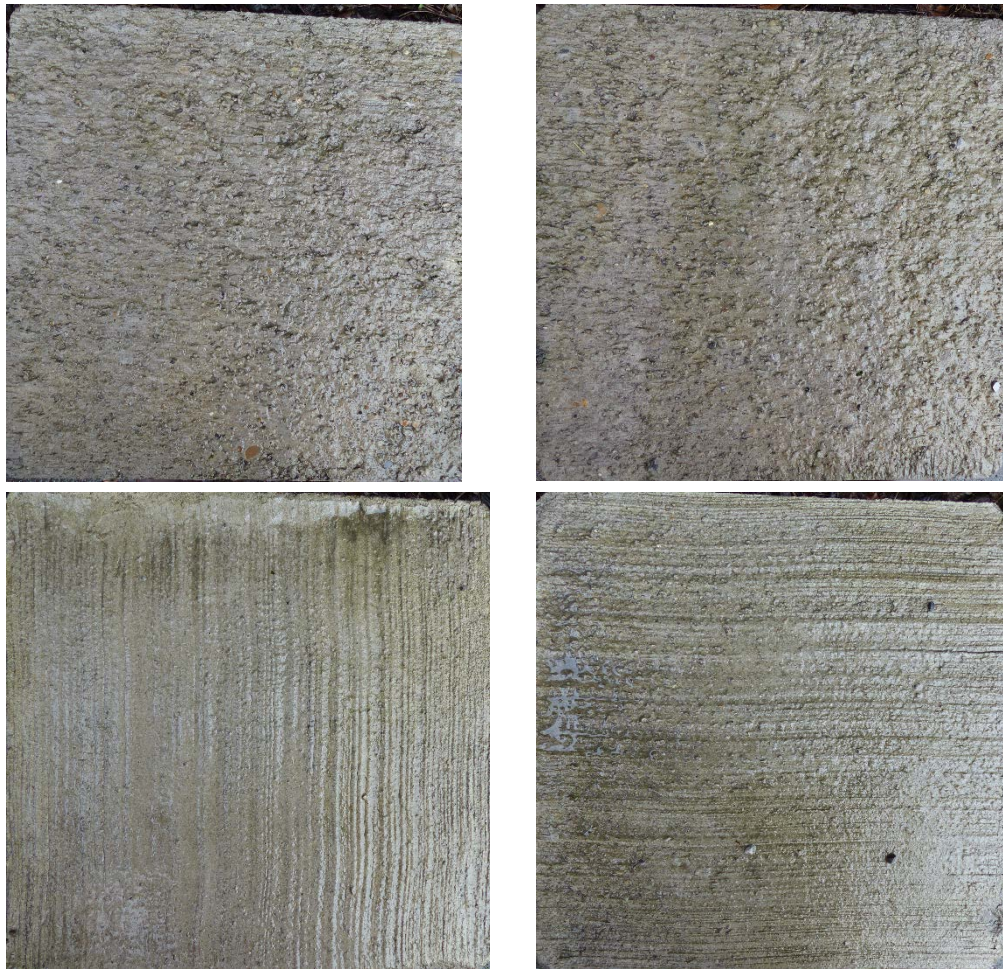
Abb. 20 Zustand der Versuchsplatten am 14.05.2014. Oben: Beton 5. Unten: Beton 12 (jeweils linke und rechte Platte, Blickrichtung Südwesten).
